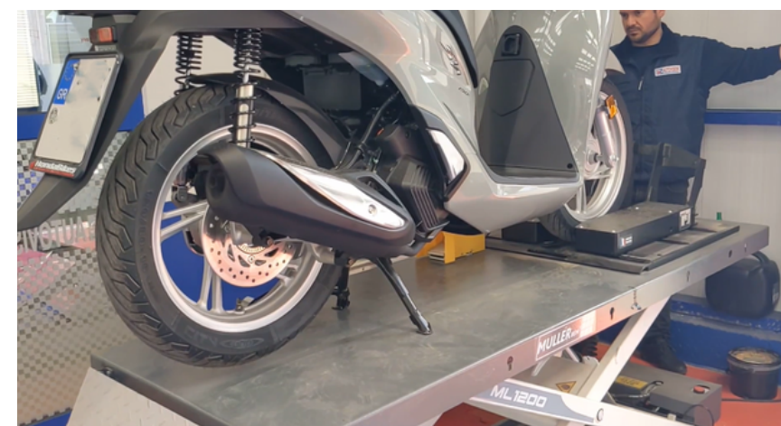
Option : table élévatrice, avec capacité minimale de 500 kg et un bloc roue
