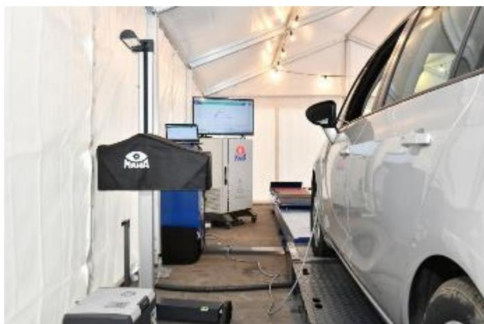
L'avis des experts est unanime, le banc de charge est la méthode la plus fiable et précise pour mesurer le niveau de pollution des véhicules. Elle s'oppose à la méthode de contrôle actuelle qui effectue les mesures à partir des émanations du pot d'échappement en accélération libre.
